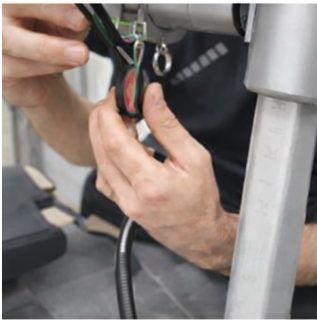
Abb. 6 — Schienenschraube lösen und Stange einsetzen
