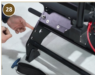
Federsteg-Bereich am Bodenrahmen vorbereiten
