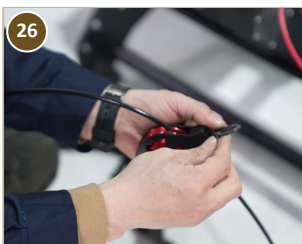
Pulley-Rad mit Karabiner verbinden
